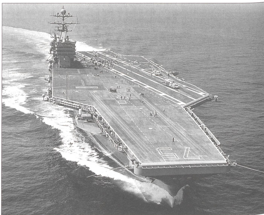
Der neueste Flugzeugträger der US Navy, die «USS Harry S. Truman», auf einer Versuchsfahrt vor der Küste von Virginia. Deutlich kommen die riesigen Ausmasse des über 330 m langen und 77 m breiten Flugdecks zum Ausdruck. Klar zu erkennen sind auch die zwei Katapultbahnen auf dem Vorderdeck und die schräg zur Schiffsachse verlaufende Landebahn. Hier sind zwei weitere Katapulte eingebaut.
