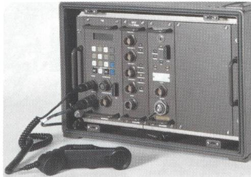
Dienstkanal und Fernbetrieb integriert. Nach wie vor ermöglicht das BSG 93 die Verschlüsselung von Richtstrahlstrecken, die mit den Stationen R-902, R-915 oder R-916 ausgerüstet sind.
