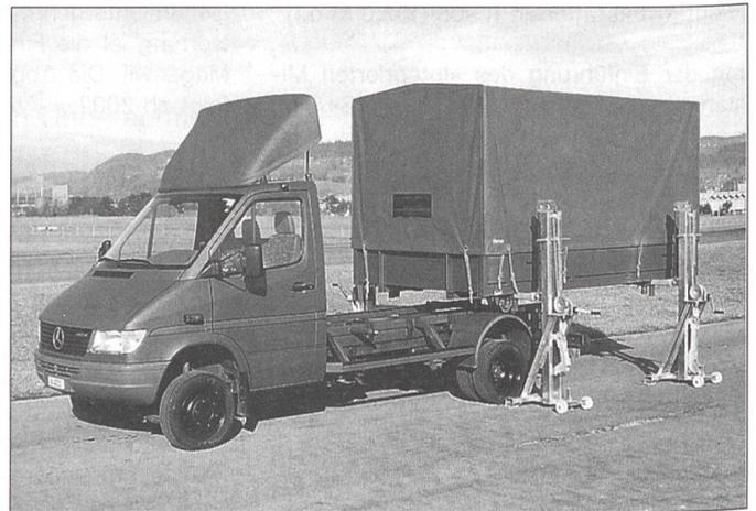
Aufbauwechsel mittels Hubstützen
