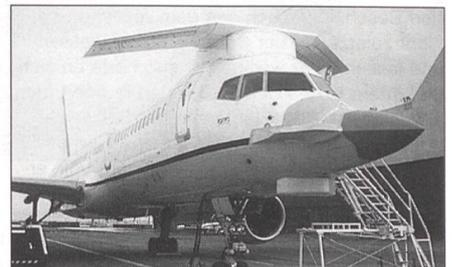
**Boeing-eigenes Testflugzeug Boeing 757 mit der Elektronikausrüstung der F-22A Raptor.**
