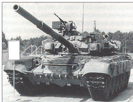
T-90-Kampfpanzer aus Russland: 46 Tonnen, 3 Mann Besatzung, 125-mm-Kanone.
