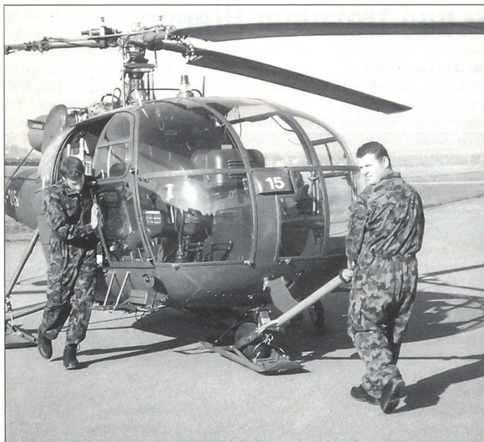
Eine Alouette 3 wird auf die Platte gezogen. Dadurch kann der Helikopter mit Muskelkraft verschoben werden.
