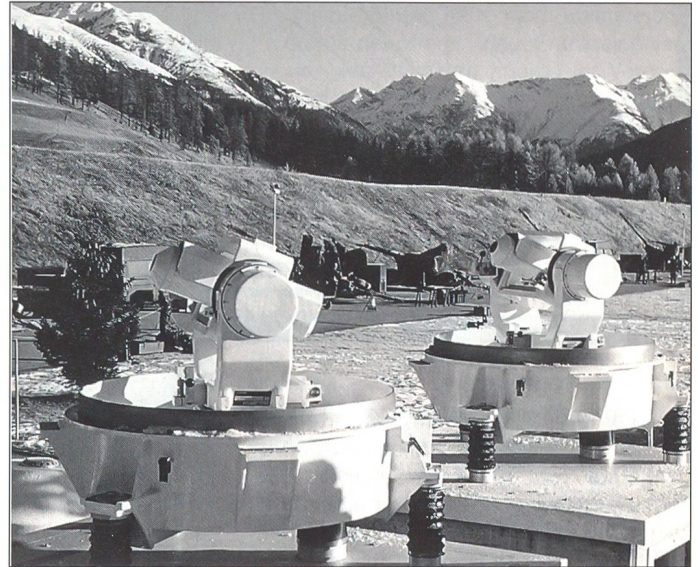
Schussfehler- und Trainingsanlage SFV 90. 2 Messstationspaare «Mounts» dienen auch der Auswertung von Sack- und Spiegelschiessen.
