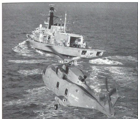
Merlin, im Hintergrund eine Fregatte der RN mit gut sichtbarem Landedeck und offenem Hangar
