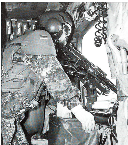
Der rechte Doorgunner am MG3 (Kal. 7.62x51). Ein Gurt fasst 120 Schuss und muss anschliessend nachgeladen werden.
