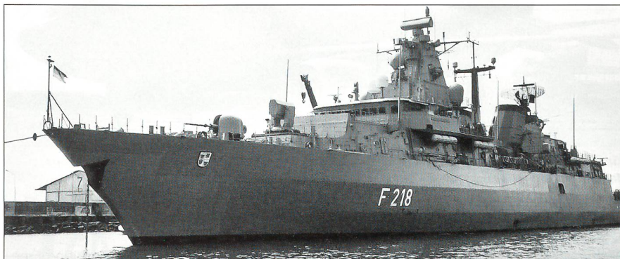
Die Fregatte F 128 «Mecklenburg-Vorpommern» im Hafen von Dschibuti. Die 76-mm-Schiffskanone und das Flugkörperabwehrsystem RAM im vorderen Teil des Buges sind gut zu erkennen.
