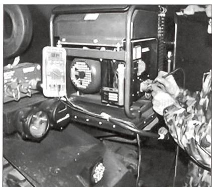
Überprüfen der elektrischen Anlage durch den Diagnostiker.
