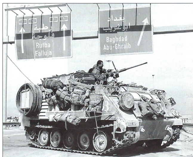
Ein M-113-Schützenpanzer des 3rd Squadron/7th Cavalry sichert in einem Vorort von Bagdad eine Kreuzung (Aufnahme vom 3. April 2003). Dieses Bataillon ist das Aufklärungselement der 3. Infanteriedivision. Die Packungen der Besatzung sind seitlich angehängt, sie dienen damit gleichzeitig als zusätzlicher Schutz gegen Beschuss.
