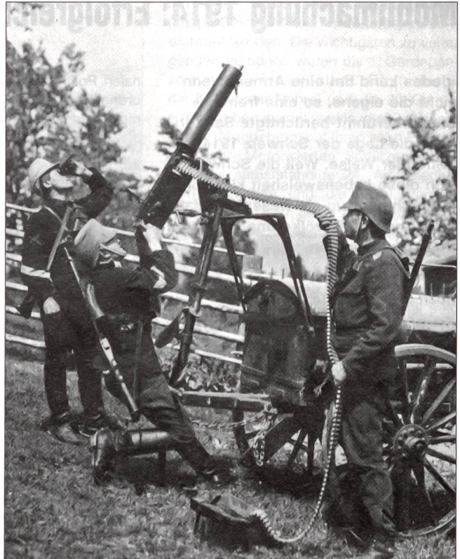
Ein Maschinengewehr, Mod. Maxim 1911, in Fliegerabwehrstellung auf einem Munitionswagen montiert.
