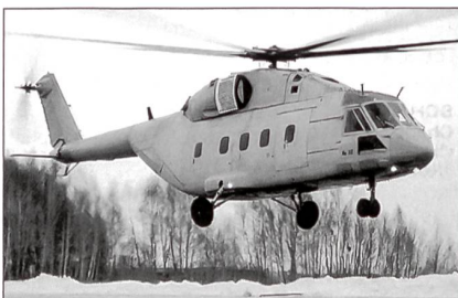
Prototyp Euromil Mi-38, ausgerüstet mit Triebwerken von Pratt & Whitney Canada
