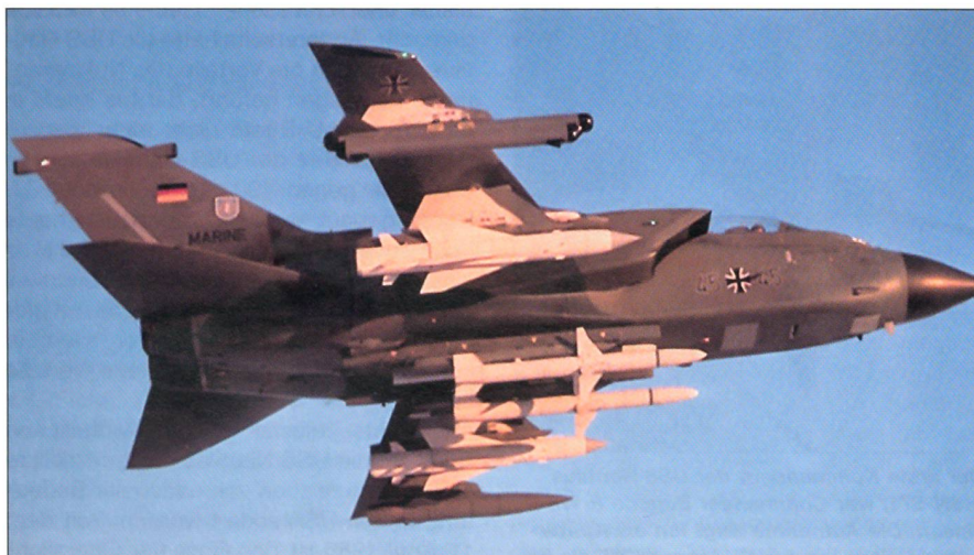
Ein Marine-Tornado mit Kampfbeladung: Zwei Anti-Radar-Raketen am Rumpf und zwei Anti-Schiff-Raketen unter den Tragflächen.
