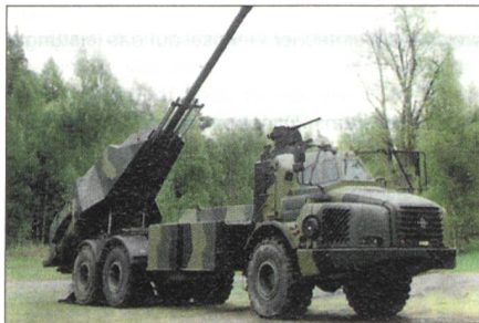
FH-77 BW L52 auf Volvo-6x6-Geländefahrzeug.
