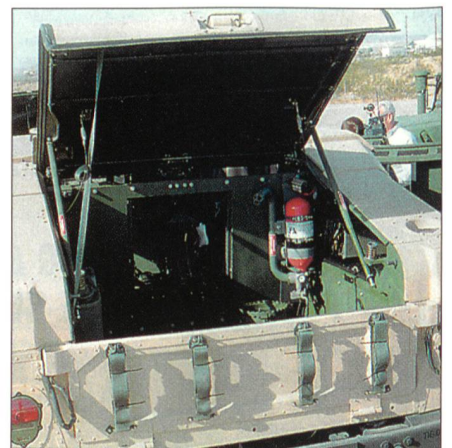
HMMWV mit Feuerunterdrückungssystem und vergrößerter Heck(Not)Ausstiegsluke.
