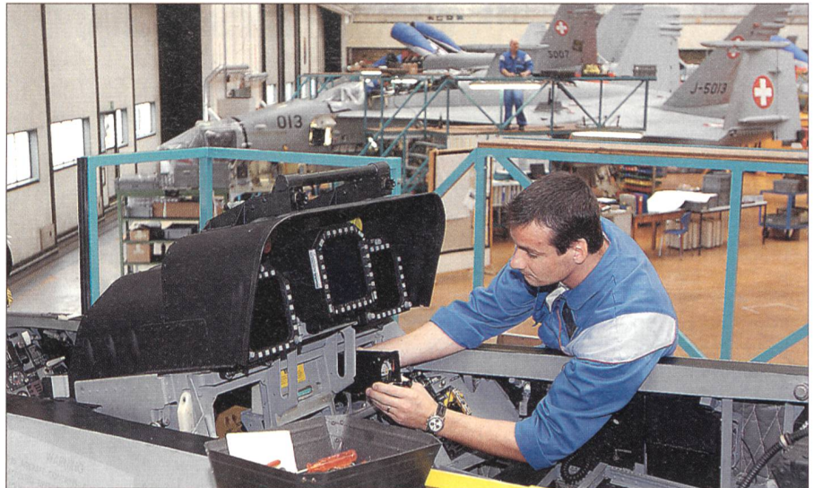
Der zur Zeit laufende Upgrade 21 an den F/A 18 Kampfflugzeugen erfordert das Wissen und Können der Spezialisten der RUAG. Es sind auch anspruchsvolle Anpassungen im Cockpit vorzunehmen.
