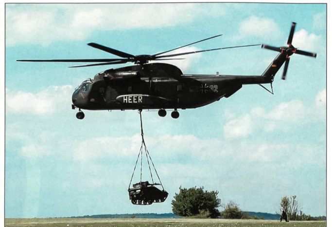
Zwei Wiesel passen in einen mittleren Transporthubschrauber (MTH) CH-53G, und er kann auch als Aussenlast transportiert werden. Die Besatzung besteht aus zwei Soldaten.
