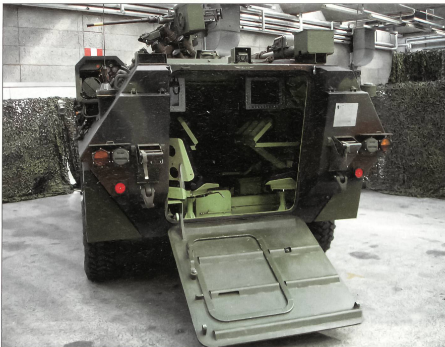
Ein Blick in das Innere eines Kommandofahrzeuges FIS HE zeigt die mit Computern ausgerüsteten Arbeitsplätze.
