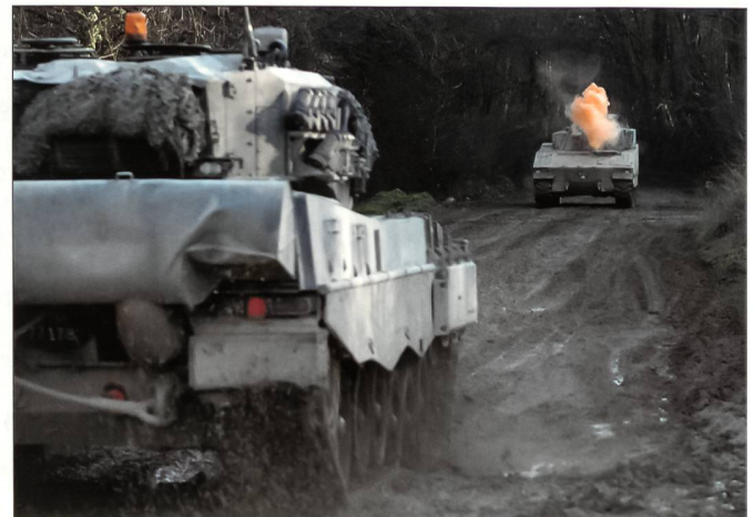
Ein Begegnungsgefecht mit dem Laserschusssimulator zwischen einem Kampfpanzer 87 Leopard WE und einem Schützenpanzer 2000. Der rote Rauch zeigt den Treffer an.
