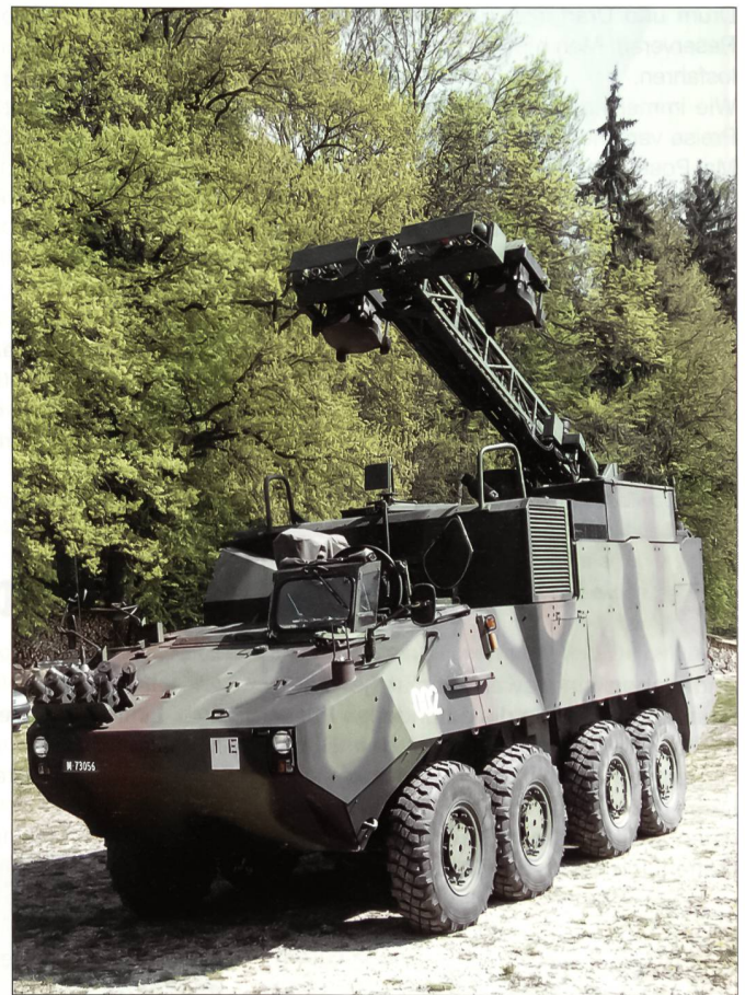
Dank dem Kommunikationsfahrzeug Piranha IIIC kann rasch eine autonome Telekommunikationsinfrastruktur aufgebaut werden.
