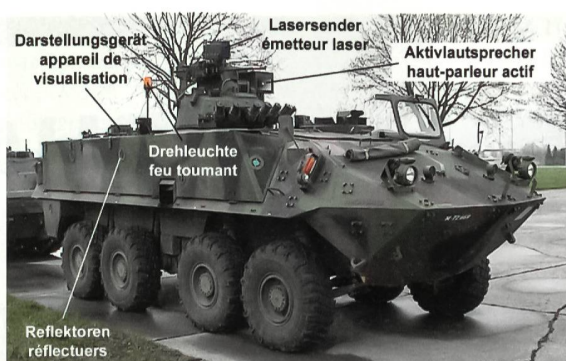
Die Simulatorausrüstung mit Lasersender, Reflektoren, Empfänger, Darstellungsgesetz, Drehleuchte und Aktivlautsprecher.
