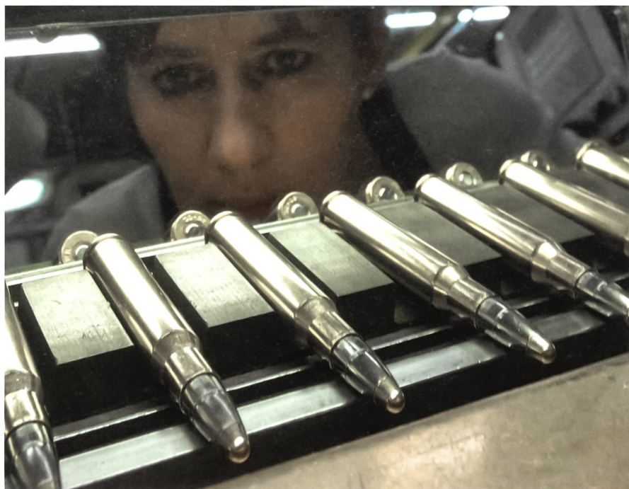
Optische Qualitätskontrolle während der Herstellung von qualitativ hochstehender Kleinkalibermunition bei der RUAG.
