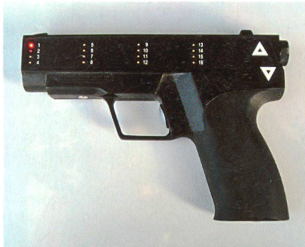
Die Schiessrichterpistole für die Ausbildung mit SIMUG und SIM KIUG.
