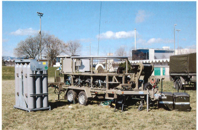
Bodenstation Fesselballon mit Winde und Gasflaschen.
