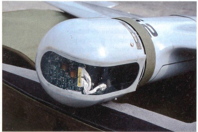
Modulare Sensoreinheit am Kopf der Minidrohone.
