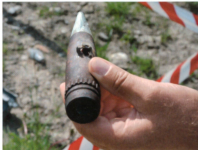
Blindgänger-Vernichtung: 35 mm Flab-Geschoss (inert) beschossen mit KMB Ldg 33 mm.
