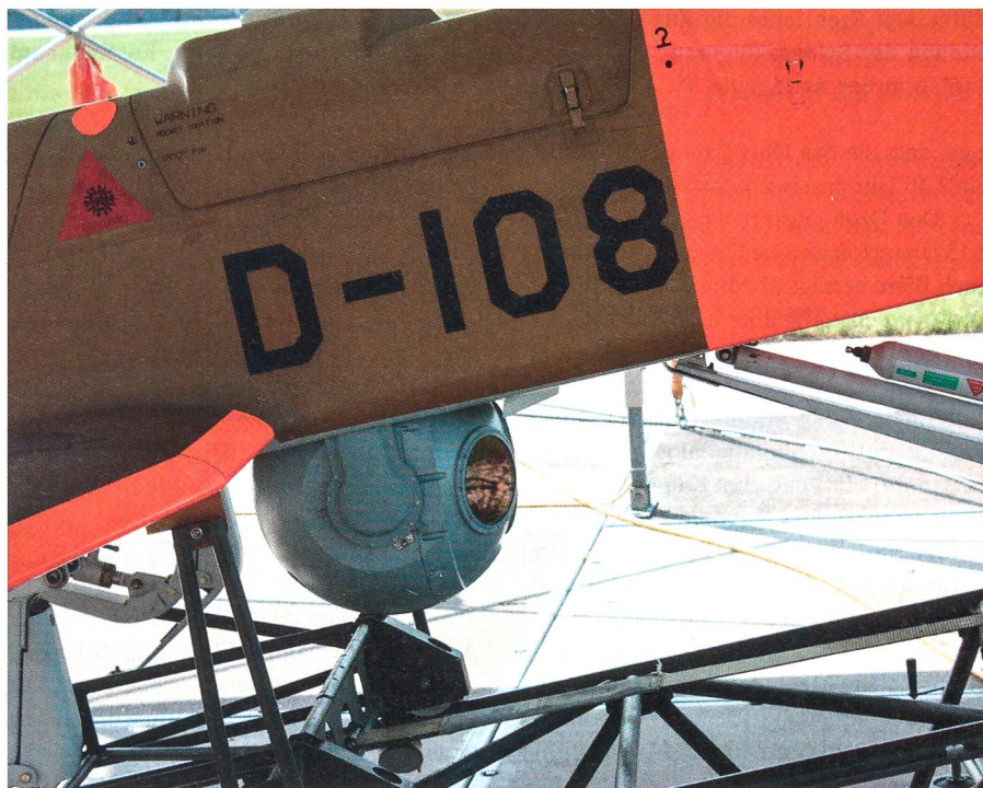
Die Aufklärungsdrohne ADS 95, gut erkennbar die runde Hochleistungskamera.
