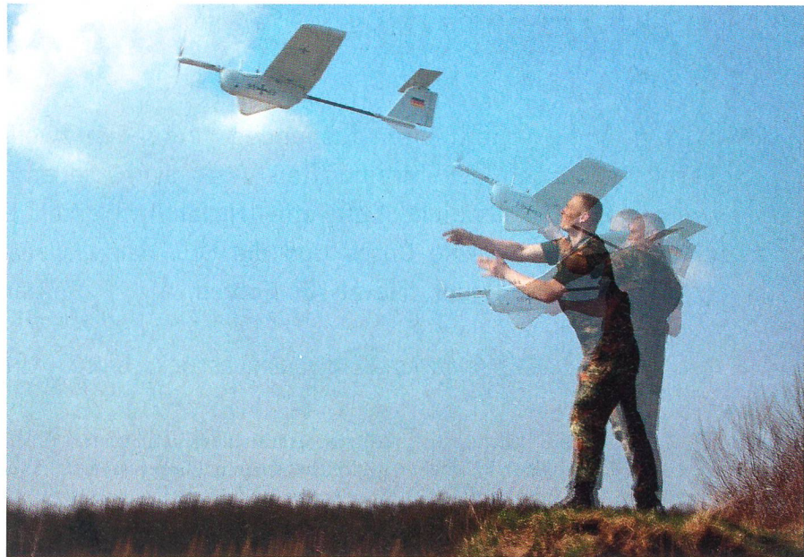
Das ALADIN-Fluggerät ist in wenigen Minuten zusammengebaut und entweder von Hand oder mit einem Bungee-Seil gestartet. Es kann eine Fläche von 30 km Durchmesser abdecken, klärt auf, identifiziert und ortet in Echtzeit.
