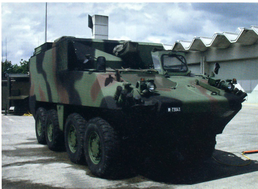
Ein Radschützenpanzer FIS im Auenfeld zu Frauenfeld. Unverkennbar ist es ein MOWAG Piranha. Typisch für den FIS-Panzer ist der Aufbau über dem Dach.
