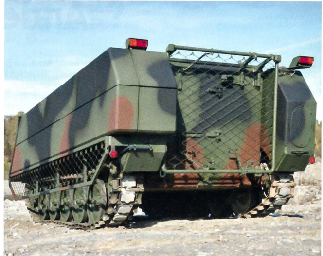
Hier sieht man die Möglichkeiten des Kunden in der Montage von SidePRO-LASSO und SidePRO-RPG am Schützenpanzer.
