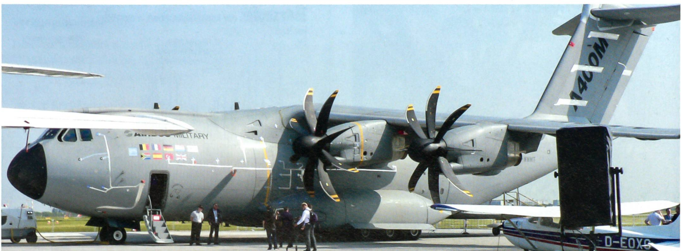
Der A400M mit seinen auffallend grossen Propellerblättern. Die Turbinen drehen nicht alle in der gleichen Richtung. Pro Seite dreht ein Triebwerk in der Gegenrichtung. Diese Lösung musste gewählt werden, damit die Struktur der Maschine die enormen Kräfte der Triebwerke aushält.
