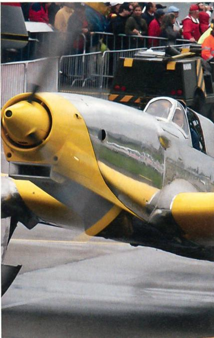
Eine Schweizer Konstruktion, das Zielschleppflugzeug C-3605.
