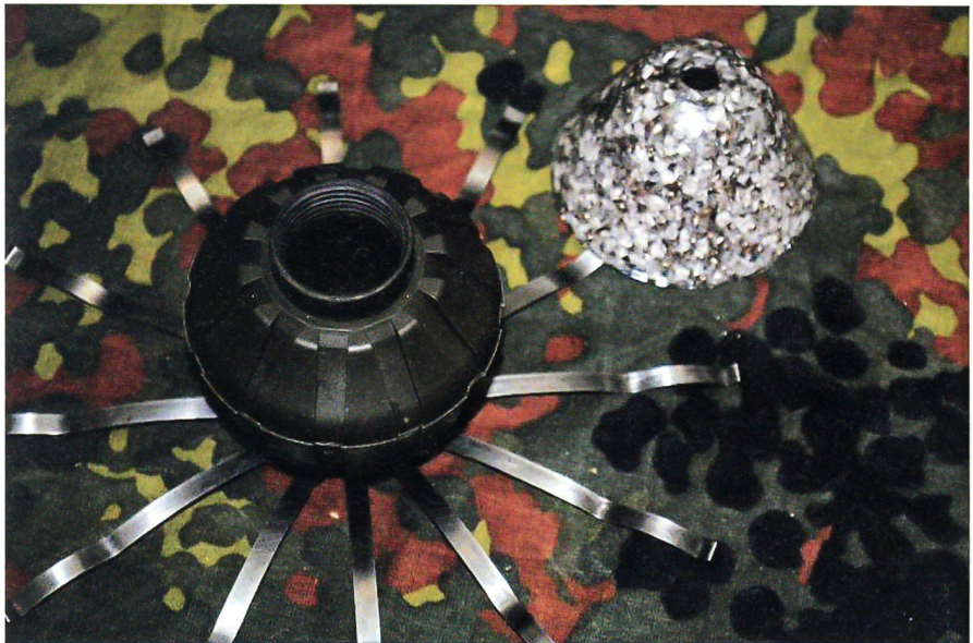
Die springende neue Handgranate mit dem ausgebauten konischen Splitterteil.
