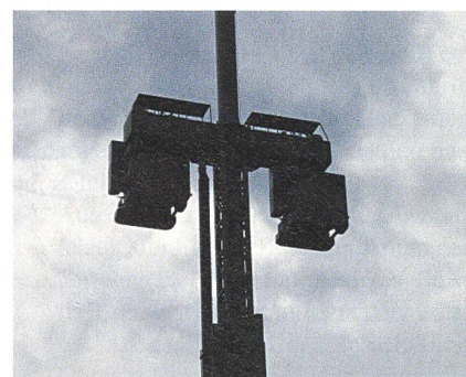
Aufgerichtet: Der Mast des RAP-Panzers.
