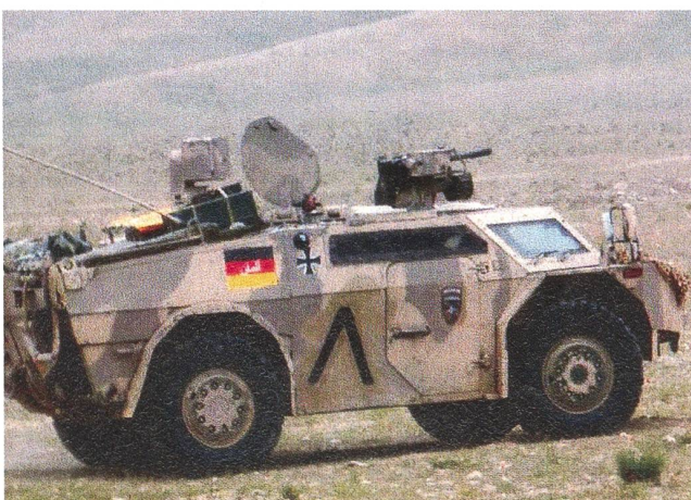
Fennek Boden/Boden, Fahrzeug für Joint Fire Support Team mit einem Beobachtungsoffizier, einem Beobachtungsfeldwebel und einem Fahrer. Lenkung des Feuers von bodengebundenen Wirkmitteln, von Kampfhelikoptern und Seestreitkräften.
