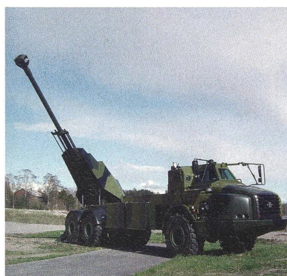
Schweden: Archer. Kaliber 155 mm. Rohrlänge 52 Kaliber. Gefechtsgewicht 34 t. Schussdistanz 40 km. Feuerschlag 3 Schuss in 13 Sekunden. Wirkungsbereich je 70 Grad. Munitionsvorrat 20 Geschosse. Bedienung drei Mann.
