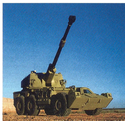
Südafrika: G6-52. Kaliber 155 mm. Rohrlänge 52 Kaliber (neueste Stufe). Gefechtsgewicht 47 t. Distanz 40 km. Feuergeschwindigkeit 4 Schuss/min. Wirkungsbereich je 40 Grad. Munitionsvorrat 48 Geschosse. Bedienung sechs Mann.
