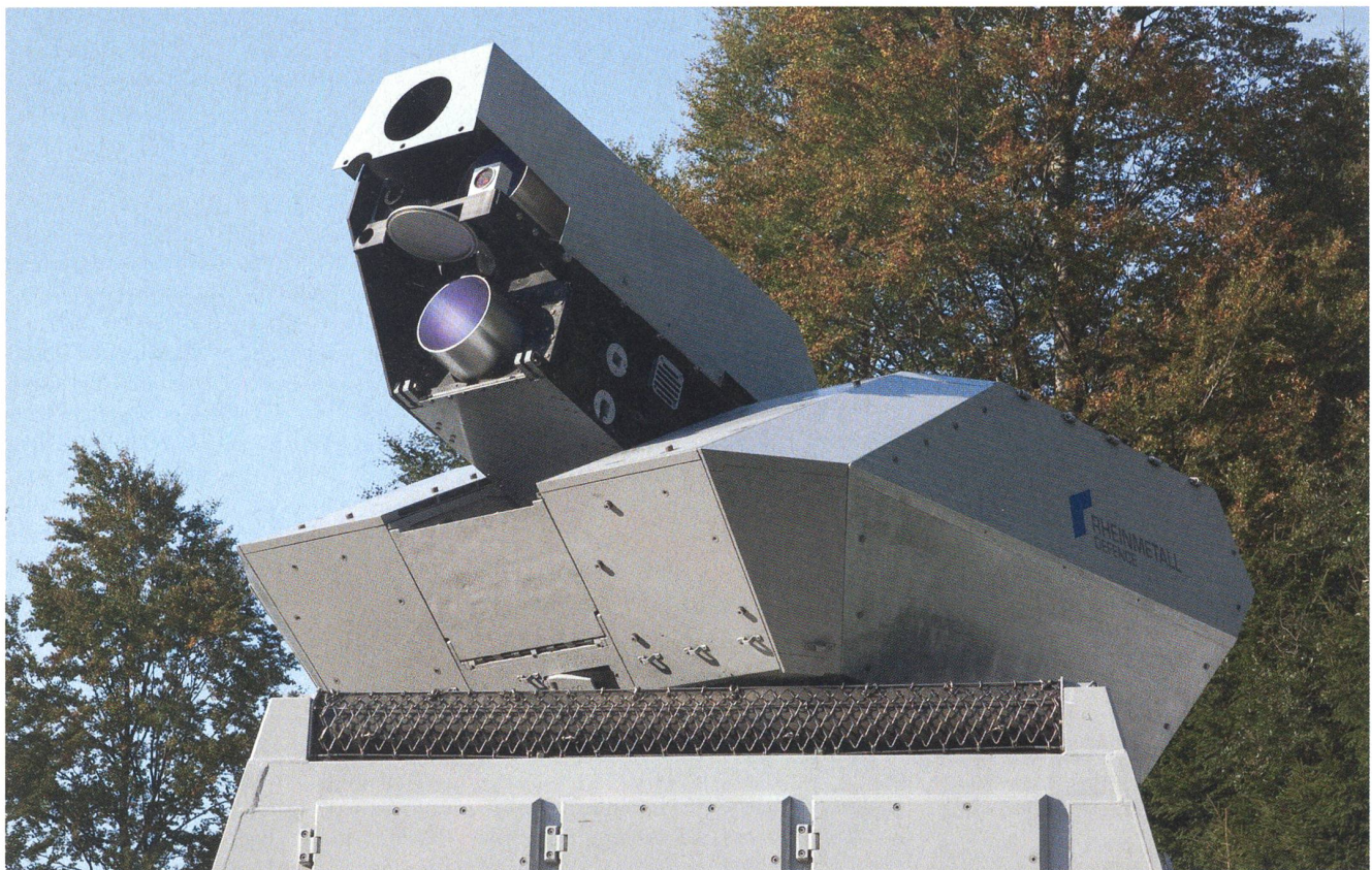
Verwendet wird der Turm von Skyshield mit dem Laserstrahler, den optischen Zielerfassungs-, Zielverfolgungs- und Vermessungssystemen.
