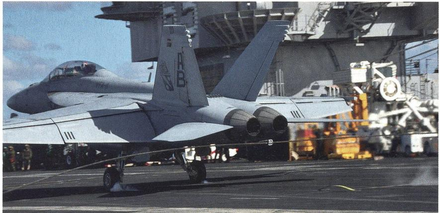
Eine F/A-18F der Fighter-Attack Squadron VFA-11 («Red Rippers») landet auf der USS «Enterprise» und erwischt das Fangseil Nummer 2 (von vier Fangseilen). Die mit etwa 240 km/h anfliegende Maschine wird dann auf einer Strecke von etwa 140 Metern zum Stillstand gebracht.
