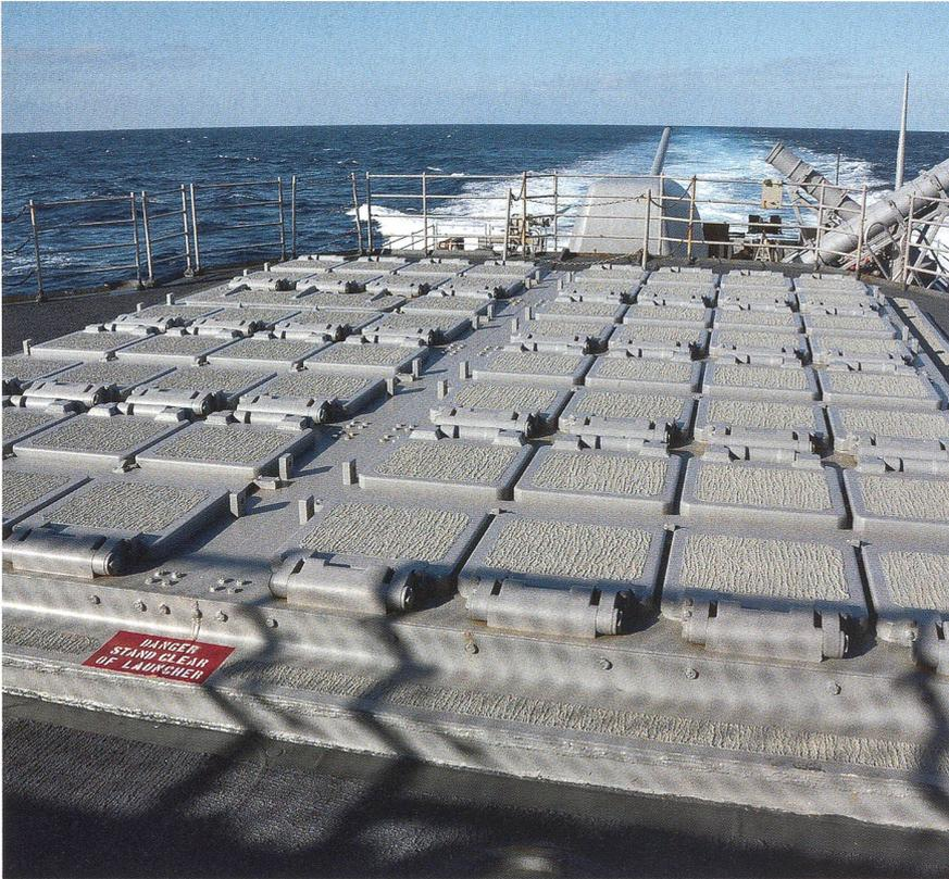
Zur Hauptbewaffnung der USS «Leyte Gulf» (CG 55) gehören zwei VLS (Vertical Launch Systems), welche über je 61 Startschächte für «Standard» SM-2 See-Luft-Lenk Waffen, «Tomahawk»-Marschflugkörper und «Asroc» Torpedos enthalten. Diese Aufnahme zeigt das VLS am Heck, ein 12,7 cm Geschütz sowie die acht «Harpoon» Schiff-Schiff-Werfer.
