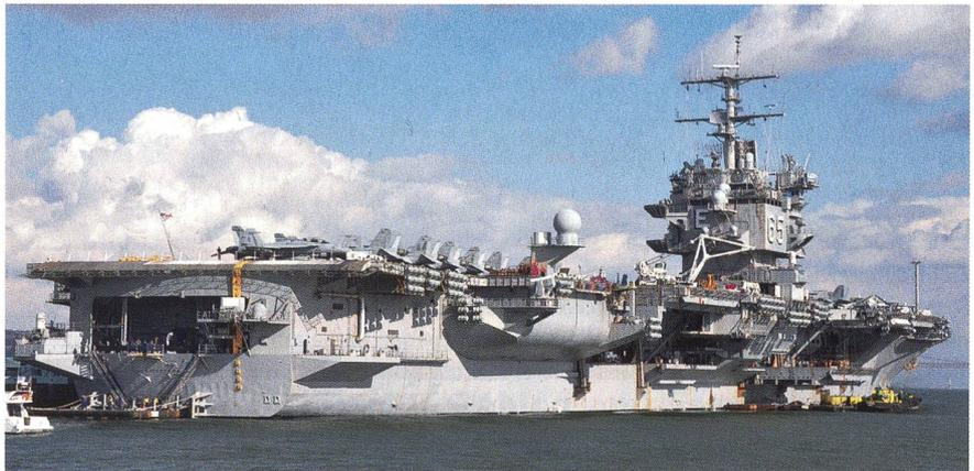
Ein Aufnahme der USS «Enterprise» (CVN 65) am Tag vor dem Auslaufen aus Lissabon. Der Träger ist 338 m lang, 77 m breit und verdrängt 95 000 Tonnen. An Bord sind 61 Flugzeuge des Marineflieger Geschwaders 1.
