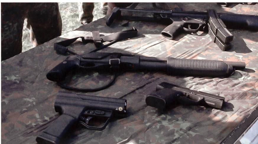
**Das Arsenal: Neben der geheimen Unterwasserpistole P11 von HK, die fünf elektrisch gezündete Pfeile in 7,62 mm x 36 verschießt, kommt auch die Remington Shotgun 870 als Aufbruchwerkzeug zum Einsatz.**
