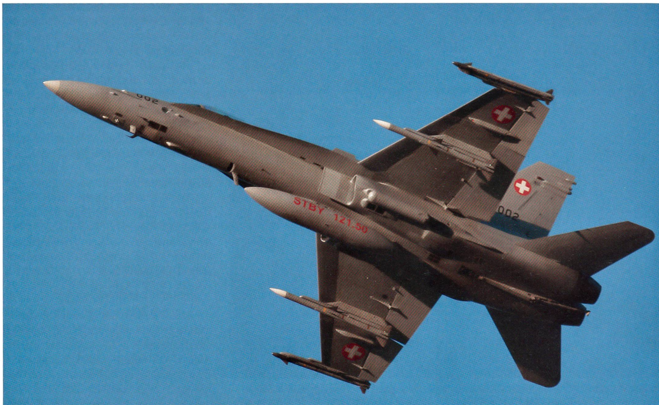
F/A-18C Hornet in der Standardbewaffnung. Zwei AIM-120B und zwei AIM-9X, in der Mitte ein Tank.
