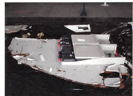
Trennwand mit Klappsitzen für die Crew.
