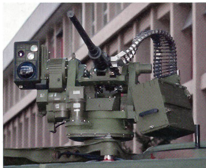
Oto Melara Hitrole mit schwerem MG im Kaliber 12,7 mm.
