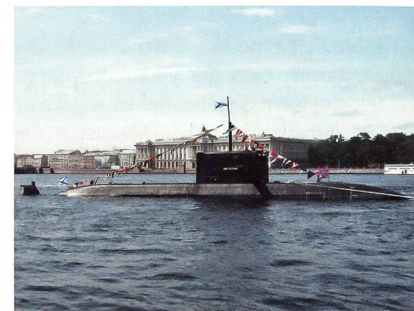
Konventionelles U-Boot Amur-1650 mit aussenluftunabhängigem Antrieb.
