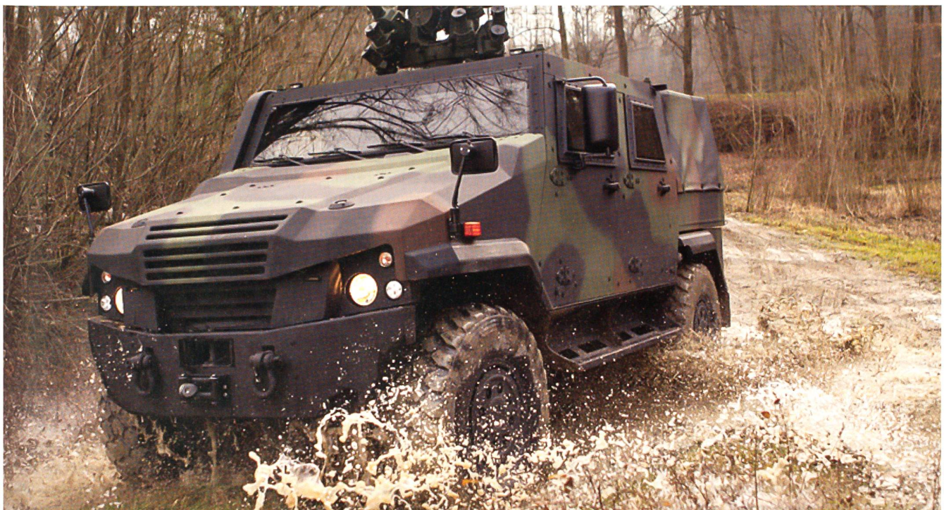
Der Mowag EAGLE V wird angetrieben vom 245-PS-Cummins-Turbodieselmotor – mit Allison-5-Stufen-Automatikgetriebe.
