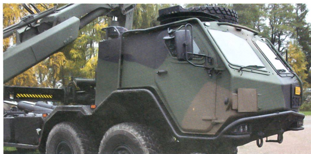
Sisu 8x8. Man beachte den starken Minenschutz unter der Kabine und die Placierung von Fahrer/Beifahrer vor der Achse.
