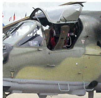
Ka-52 mit breitem, dopsitzigem Cockpit: Jeder Pilot kann die Steuerung übernehmen.
