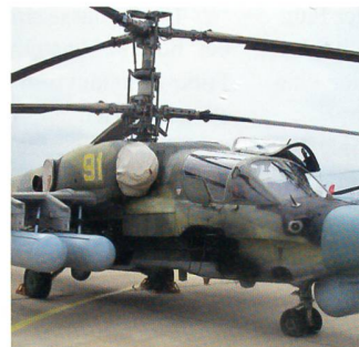
Zwei Gasturbinenmotoren VK-2500 tragen den Ka-52-Alligator auf über 5000 Meter Höhe.
