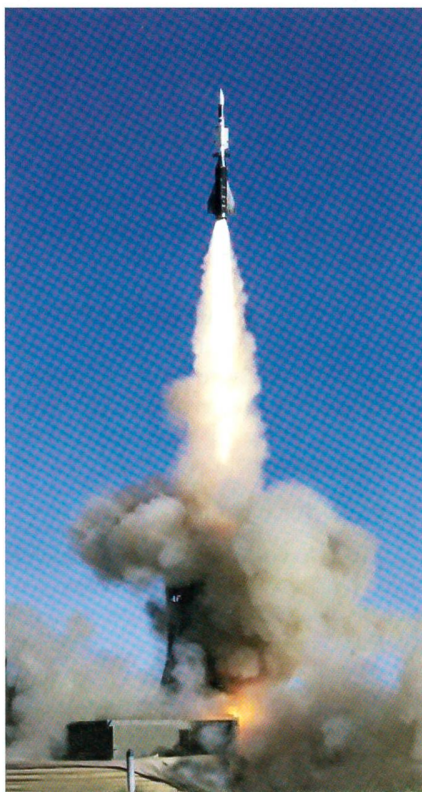
Eine Mittelstreckenrakete Aster 30 der Firma MBDA für den Boden-Luft-Einsatz kurz nach dem Abschuss von einer auf einem Lastwagen montierten Lafette.
