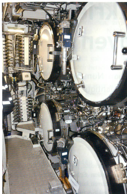
U 32 verfügt über sechs Torpedorohre vom Kaliber 53,3 cm.
