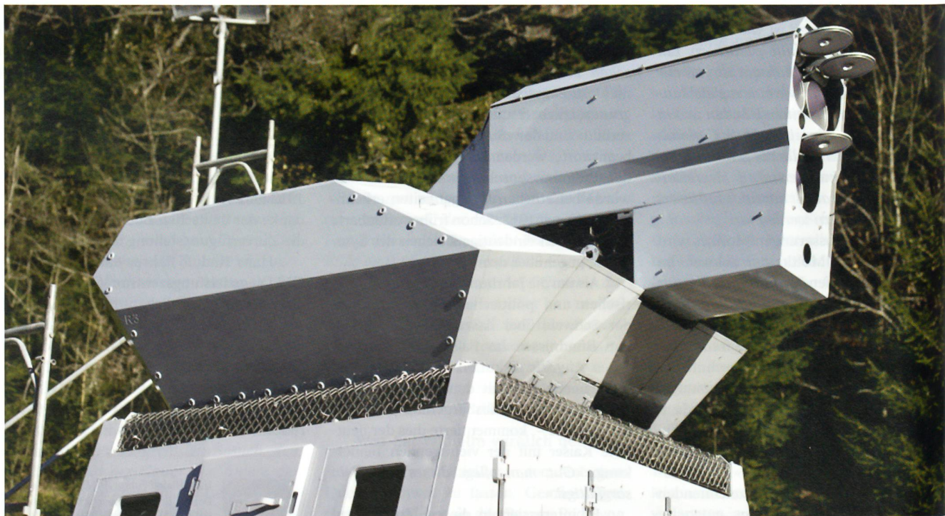
Der 30-kW-Lasereffektor ist in den Oerlikon-Revolvergun-Geschützturm integriert. Die in der Flugabwehr bewährte Feuerleittechnologie ermöglicht es, Ziele mit grösster Präzision zu entdecken, zu verfolgen und wirkungsvoll zu bekämpfen. Die Wirkung mehrerer Lasereffektoren kann auf ein Ziel gebündelt werden.
