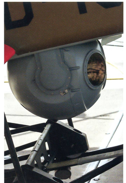
Weiter unterstützt die Luftwaffe das GSK, so mit Drohnenflügen entlang der Grenze. Hier die runde Hochleistungskamera der Ranger-Drohne ADS-95.
