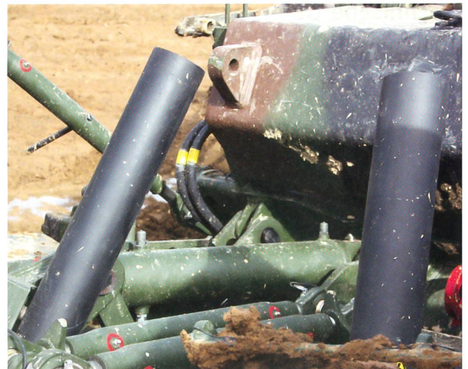
«DEMETER» sprengt Minen beim Errichten der Minengasse.
