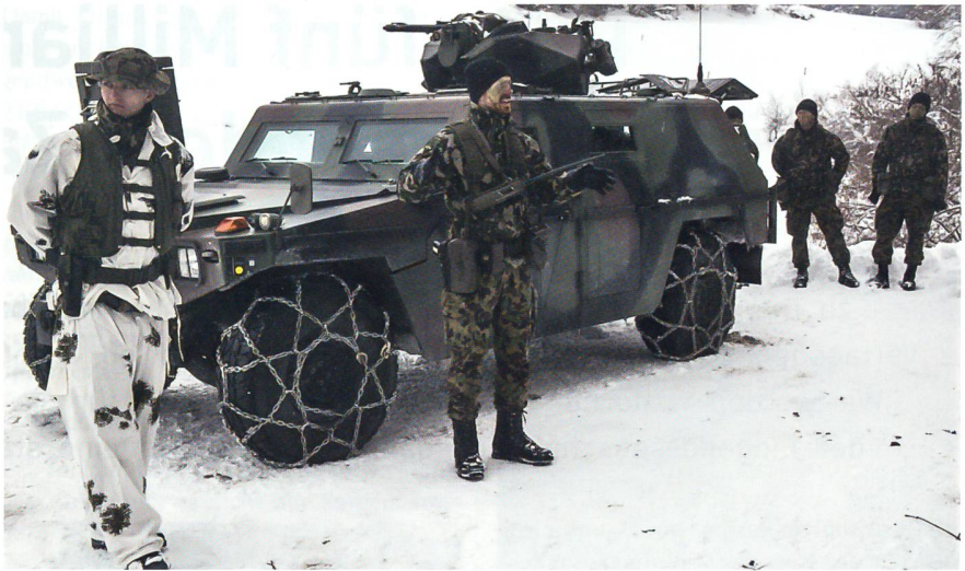
Zweimal Mowag: Der Eagle mit Vorderrad- und Hinterradketten...
